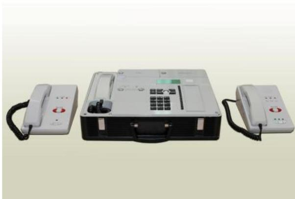
Предназначена для организации экстренной защищенной связи по телефонным сетям общего пользования, ТЧ каналам, комбинированным радиопроводным каналам связи, состоящим из стандартных каналов ТЧ, КВ-радиоканалов и соединительной линии, каналам УКВ и КВ-радиостанций, работу через спутниковую станцию и обеспечивает:
