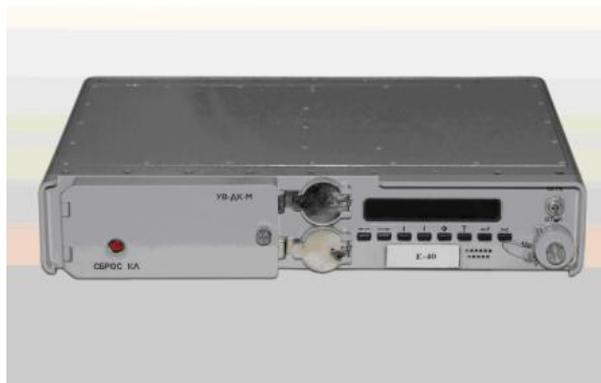
Предназначена для криптографической защиты информации, передаваемой по цифровым каналам и абонентским линиям
