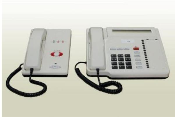
Предназначена для организации в режиме "Абонент-Секретарь" защищенного обмена речевой информацией между абонентами сети ТфОП с 2-х или 4-х проводным окончаниями на скоростях 2,4; 4,8; 9;6 кбит/с и обеспечивает:
