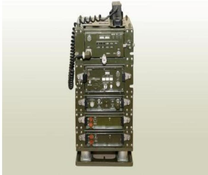
Унифицированная аппаратура шифрования телефонной информации, передаваемой в симплексном, полудуплексном и дуплексном режимах со скоростями 1200, 2400, 16000 бит/с и цифровой информации в дуплексном режиме на скоростях 1200 и 2400 бит/с.
