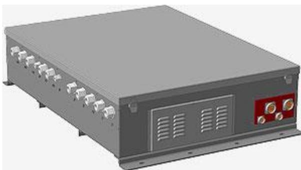
Тяговый преобразователь БУЭТ-2ЭП является электронным устройством, выполненным с учетом последних достижений в области силовой электроники с применением IGBT транзисторов с микропроцессорным управлением и предназначен для управления электроприводом двухосного троллейбуса оснащенного тяговым двигателем постоянного тока мощностью 120 кВт типа ДК 213 (или его аналог).
