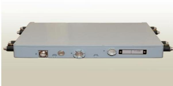
Предназначена для криптографической защиты, имитозащиты, помехоустойчивой передачи (приема) данных, их распределения между каналами связи и автоматизированными рабочими местами:
