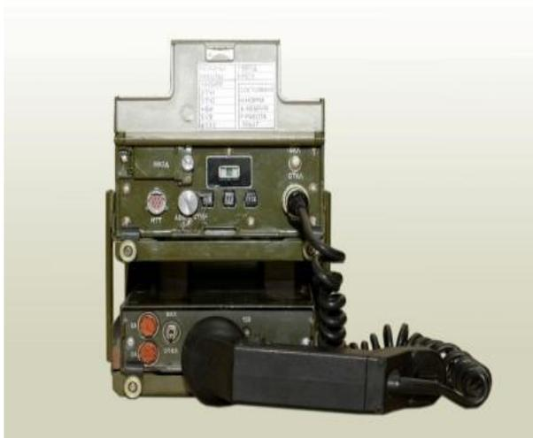
Унифицированная аппаратура автоматического засекречивания телефонной и цифровой информации Е-11Н предназначена для шифрования телефонной информации, передаваемой в симплексном режиме со скоростью 1200 бит/с по цифровым каналам, каналам тональной частоты УКВ и КВ радиостанций.
