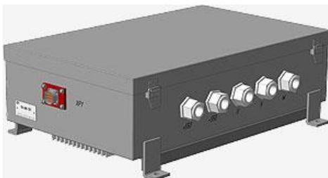
Преобразователь напряжения ПН 380-1ЭП является электронным устройством, выполненным с учетом последних достижений в области силовой электроники, с применением IGBT транзисторов с микропроцессорным управлением и предназначен для управления асинхронным электродвигателем привода компрессора троллейбуса.
