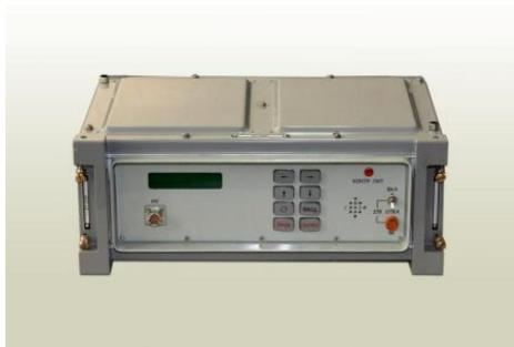
Устройство преобразования сигналов АТ-3102 предназначено для передачи и приёма дискретных сигналов по каналам тональной частоты.
