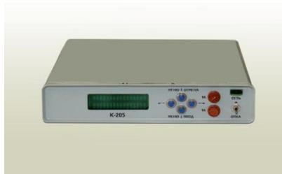
Устройство предназначено для объединения до шести потоков цифровой информации в один групповой поток и его передачу по основному цифровому каналу (ОЦК) или по четырёхпроводной физической линии по стыку С1-ФЛ.
